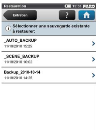
Figure 6-31 Restauration : sélection du fichier de sauvegarde
