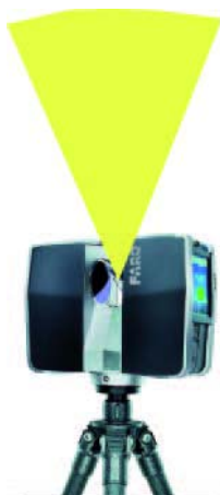
Figure 5-26 Mesure pondérée au zénith
