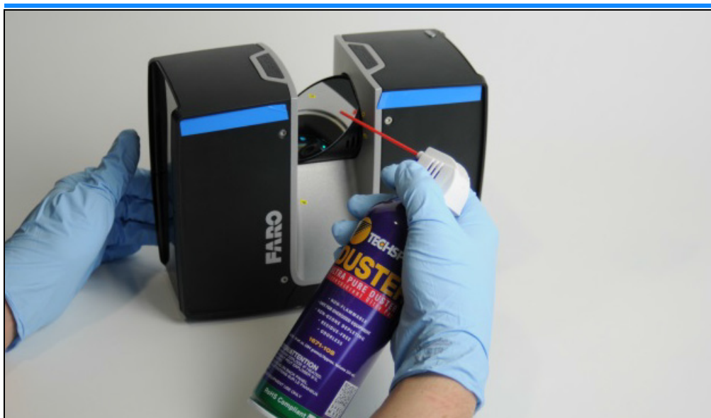
Figure 9-1 : Nettoyage préalable à sec par air comprimé ou aérosol anti-poussière
