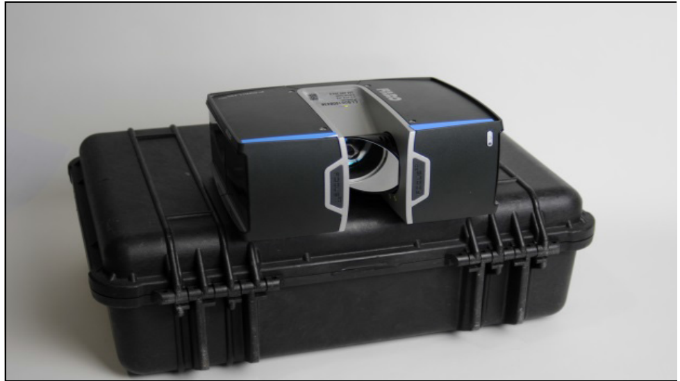
Figure 9-12 : Boîte de transport avec le scanner laser retourné et posé sur le dessus, module de miroir tourné vers l'extérieur
