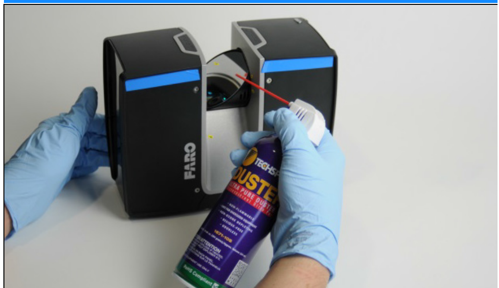
Figure 9-11 : Nettoyage préalable à sec par air comprimé ou aérosol anti-poussière
