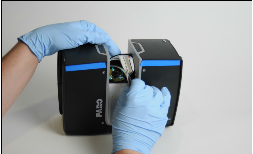
Figure 9-9 : Nettoyage du module de miroir avec un chiffon et de l'alcool isopropylique ou un liquide de nettoyage
