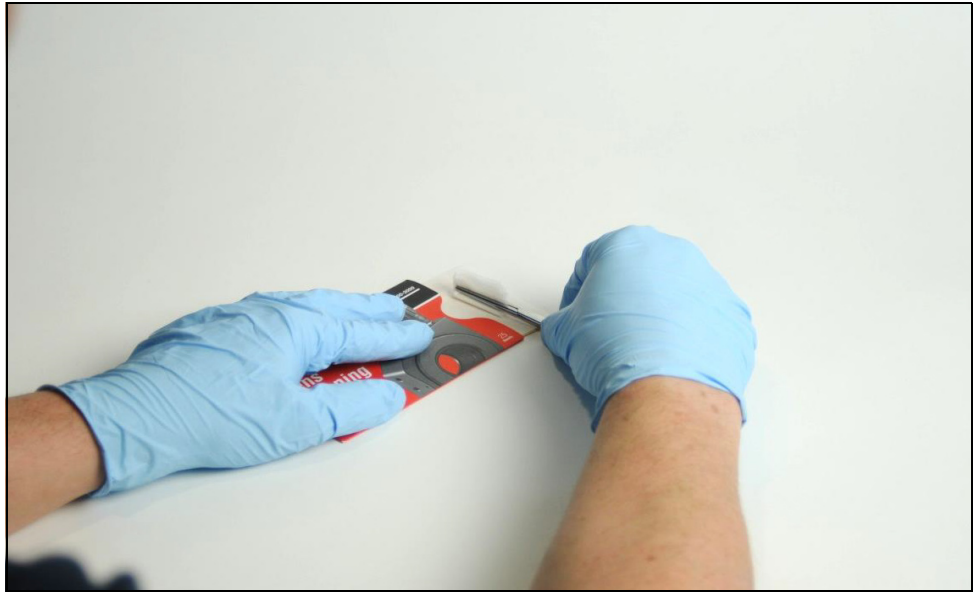
Figure 9-6 : Réalisation d'un chiffon de nettoyage en T (1)
