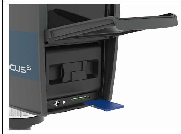
Figure 6-7 : Insertion de la carte SD
