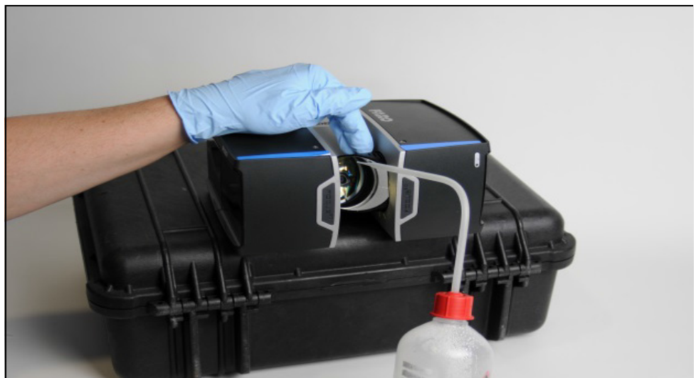
Figure 9-14 : Nettoyage du module de miroir ou du couvercle de capteur
