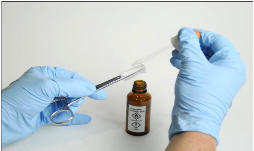
Figure 9-8 : Trempage du tissu de nettoyage
